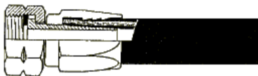
Рисунок 2 - Концевой крепеж в разрезе
